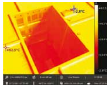
Termografický snímek části střechy školy pořízený v září 2016 dronem Správy informačních technologií města Plzně zdokumentoval teplotní rozdíly na osluněné a zastíněné části střechy, kdy v létě přesahuje teplota střechy 70°C.
